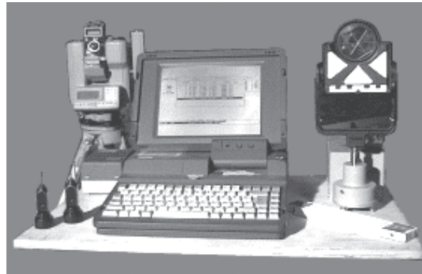
Abbildung 1: Tachimeter mit CAD-System
