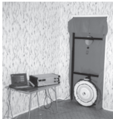
Abbildung 14: Blower Door (IEMB)
